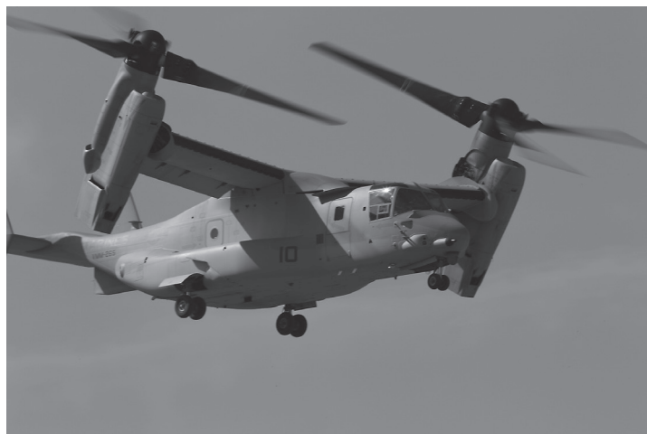
垂直離着陸機能と高速長距離移動機能を兼ね備えた点が利点とされるオスプレイ(MV-22) (©OCVB)
